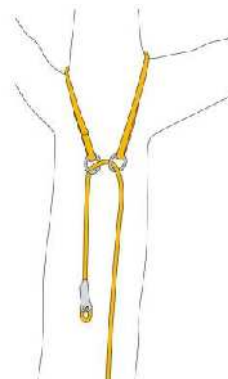
Fig. 8 - Ancoraggio passante per corda raddoppiata
